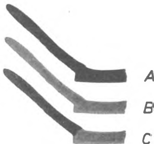
Fig. 2 - Sezioni del campione n. 3 A - allo stato originale B - dopo riscaldamento a 500° C. C - dopo riduzione, dalla parte sinistra della sezione, in corrente di idrogeno a 500° C. Ingr. x 1
